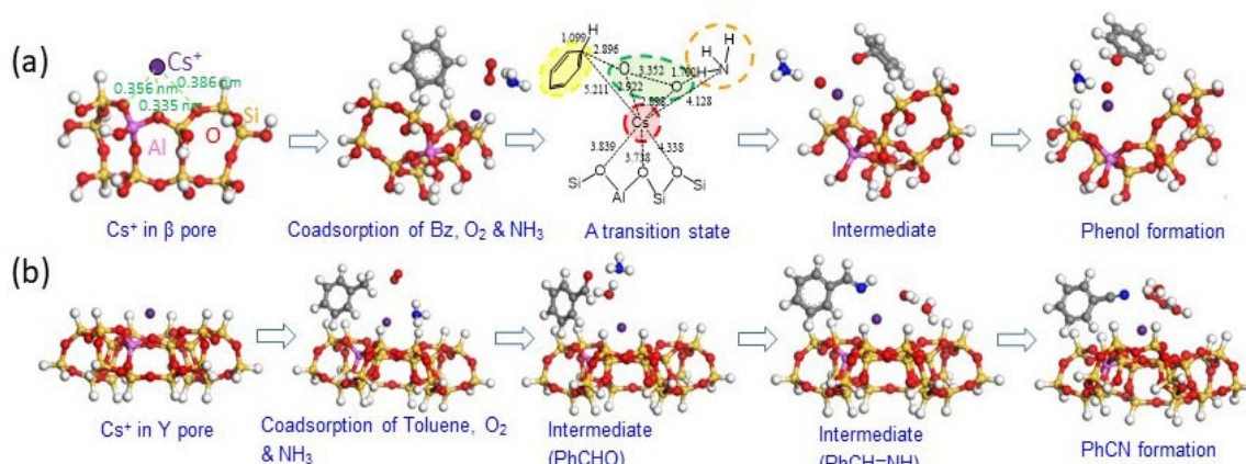
Fig. 1(a) Cs/ \beta 上のフェノール生成過程 (b) Cs/Y上のベンズニトリル生成過程
